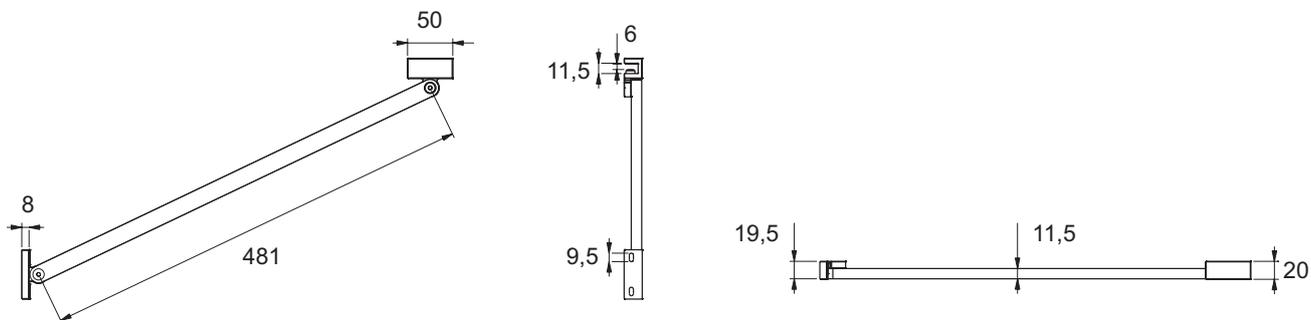
Спецификация продукта : Горизонтальная штанга 50 см . E22BT. Коллекция : CONTRA. ВЕС : 1 кг. МАТЕРИАЛ : Алюминий. ТИП УСТАНОВКИ : Крепление к стене. Совместима со стеклом 6 и 8 мм.
